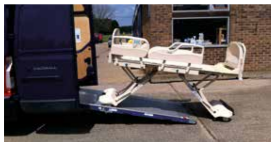
Piano in alluminio anodizzato antiscivolo
