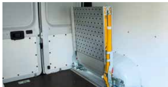
Piano in alluminio anodizzato e forato
